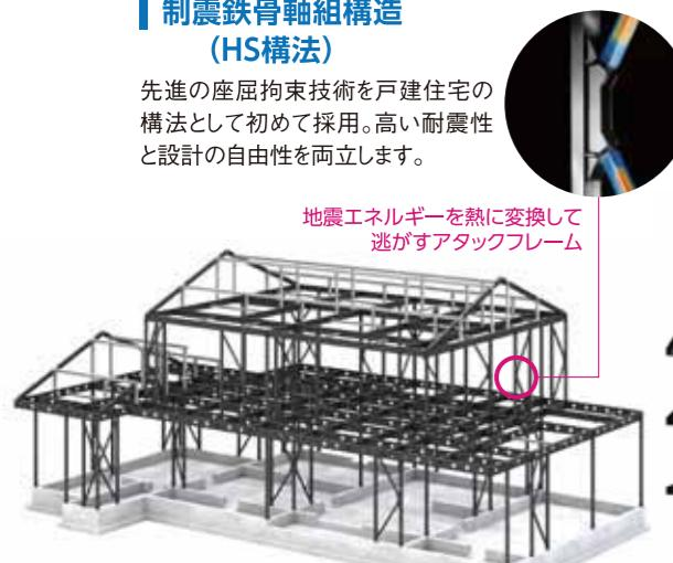
地震エネルギーを熱に変換して逃がすアタックフレーム
